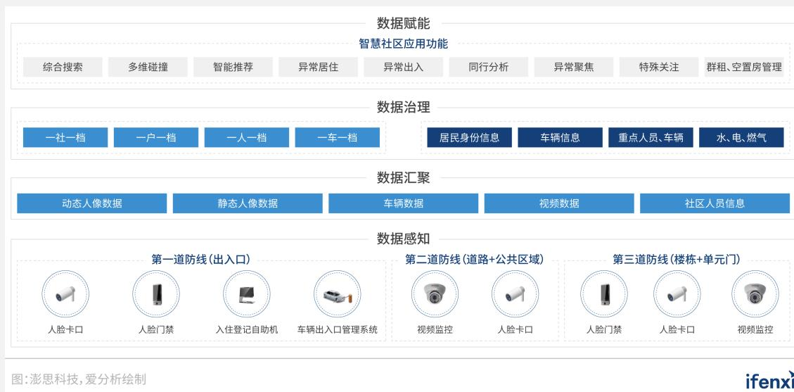
智慧社区系统架构分为数据感知层、数据汇聚层、数据治理层以及最后的数据赋能应用层。
