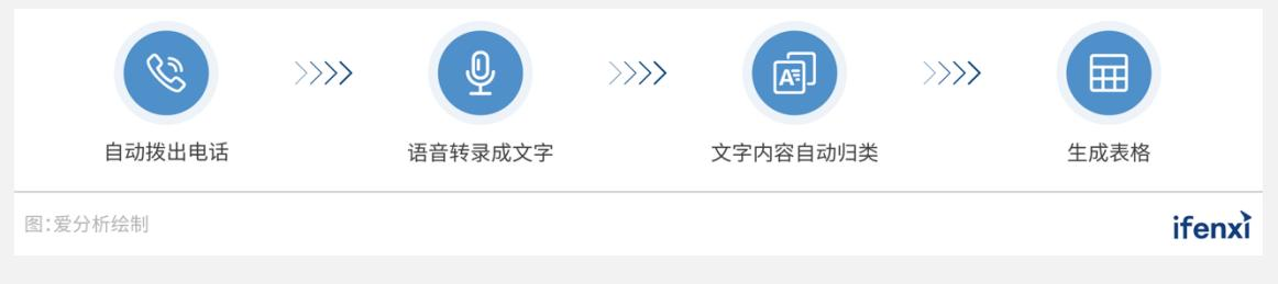
这一套 RPA+外呼机器人的解决方案可自动识别名单上的电话，自动对外拨打。通话结束后，自动保存电话通话内容，利用语音识别及语义理解技术将语音内容转化为文字；基于 RPA 技术，将文字内容进行打标签，归类整理；最后自动生成表格，整个过程都是全自动的。
