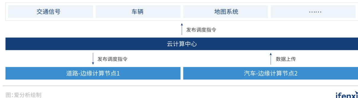
在道路边缘侧，边缘计算数据分析、缓存的能力减轻了云端数据处理的压力，提升了数据处理速度，减少了延迟；道路边缘支持离线运行、断点续传和数据选择性传输，节省了网络流量。在云计算层，云计算负责对算法进行升级，将升级后的算法推送到前端，使得设备可持续升级和更新。
